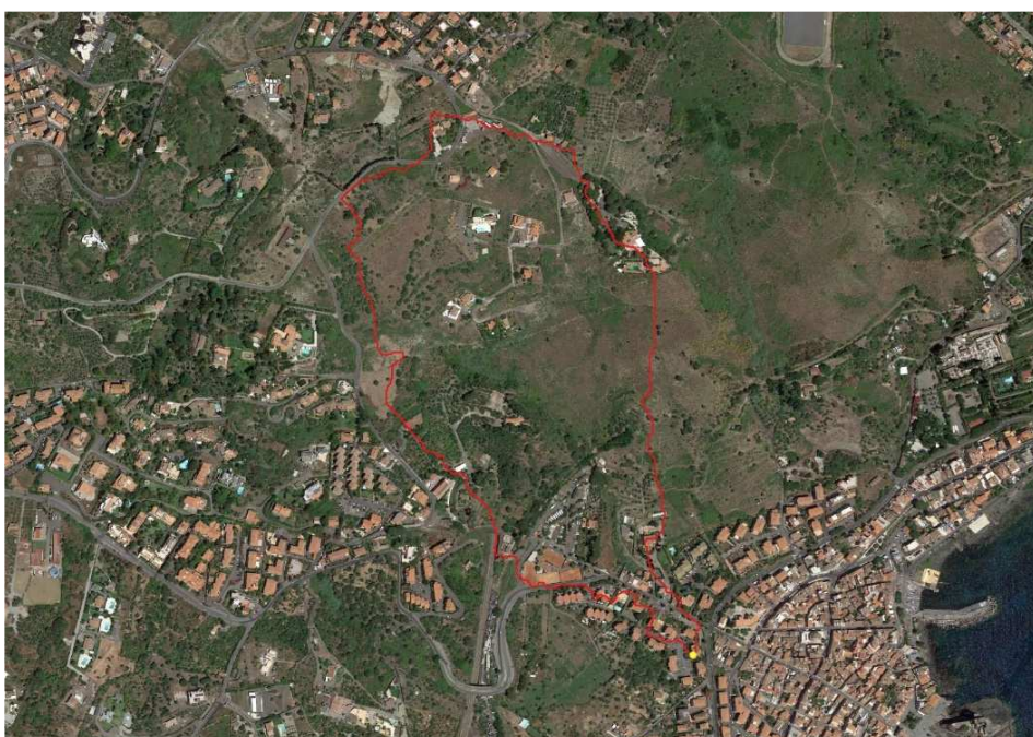
Foto 1 – Bacino di drenaggio delle acque superficiali che confluiscono nel sottopasso tra Via Stazione e SS 114 (Aci Castello).
